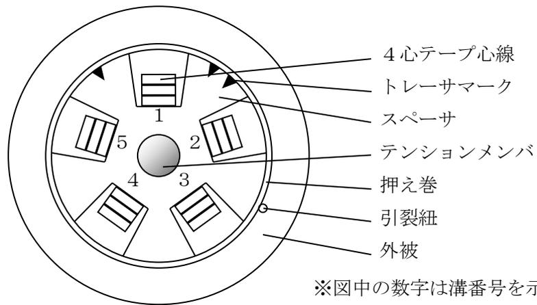
図3. ケーブル構造図 (28心~60心)
